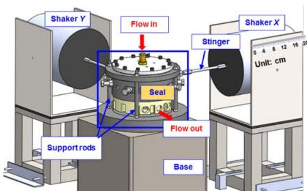
Fig. 1 TRC Wet gas seal test rig.
